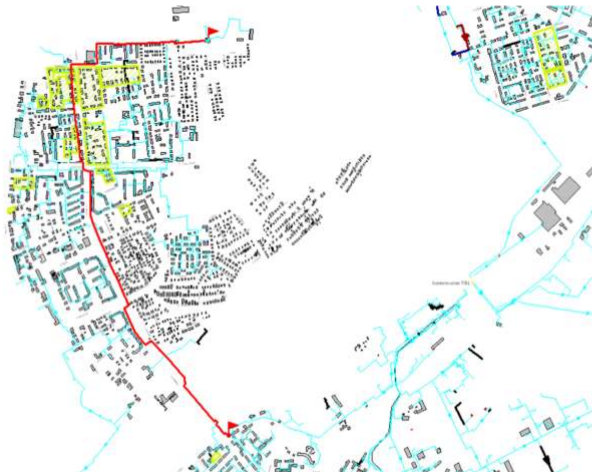
Рисунок 2.1 – Путь для расчёта вероятности безотказной работы тепловых сетей от ТК-45 до С-28п-16
