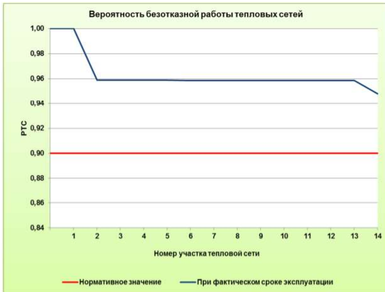
Рисунок 2.8 Вероятность безотказной работы тепловых сетей от Архангельской ТЭЦ до ТК-18т-4
